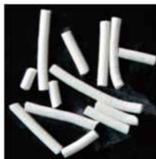
右图为成型的柱状纳米氧化锌脱硫剂 比表面积高达 60 m 2 /g 硫容量(200度)大于 20 g-S/g-cat
